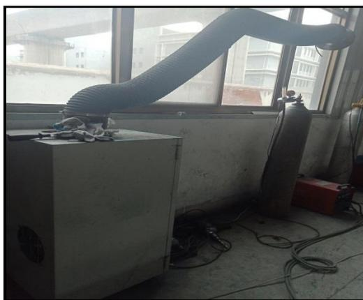
**移动式焊接烟尘处理机****②喷漆废气**
